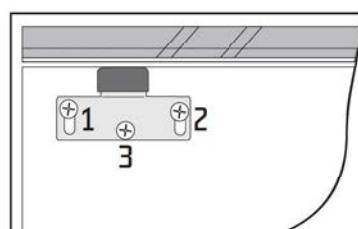
Vruty 1, 2 montovat před nasazením dveří, vruty 3, 4 po rasazení a seřízení dveří.
