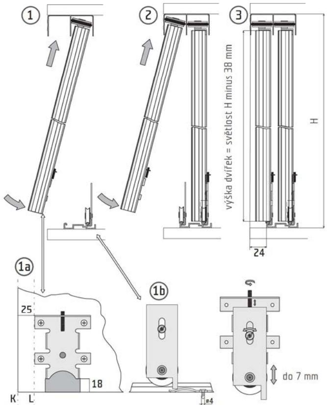
Pozor: Při montáži pevné části vozíku dbejte na to, aby osy K a L byly rovnoběžné.
