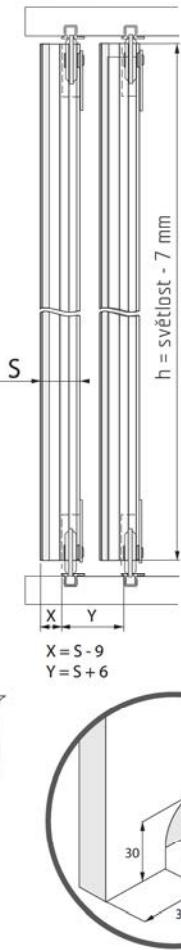
Oveřní křídlo nasazujeme nejprve do spodní kolejnice a následným stlačením kolečka horního vozíku zasadíme do horní kolejnice.
