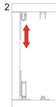
2. Po umístění dveří s vozíky do dolních lišt se zvedne horní vozík do horní lišty a po výškovém nastavení se zafixuje ve požadované poloze pomocí zajišťovacích šroubů.
